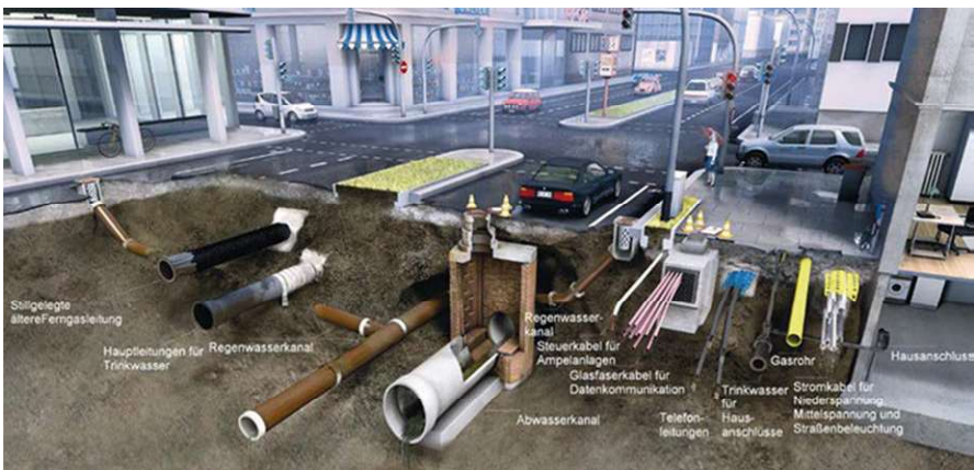
Bild 1 Versorgungsleitungen in der Straße (Quelle: E.ON)
